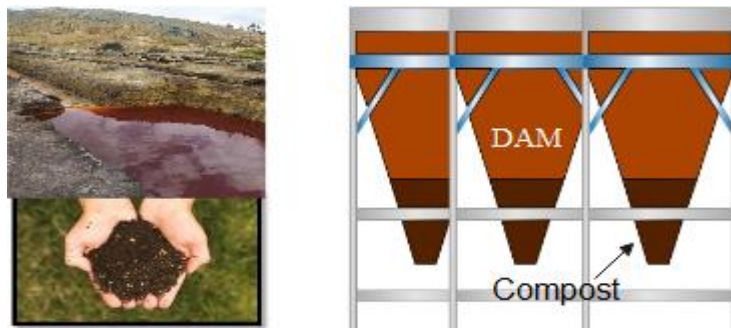
Figura 4: Instalación de Conos Imhoff para la evaluación de la influencia del compost sobre el DAM.
