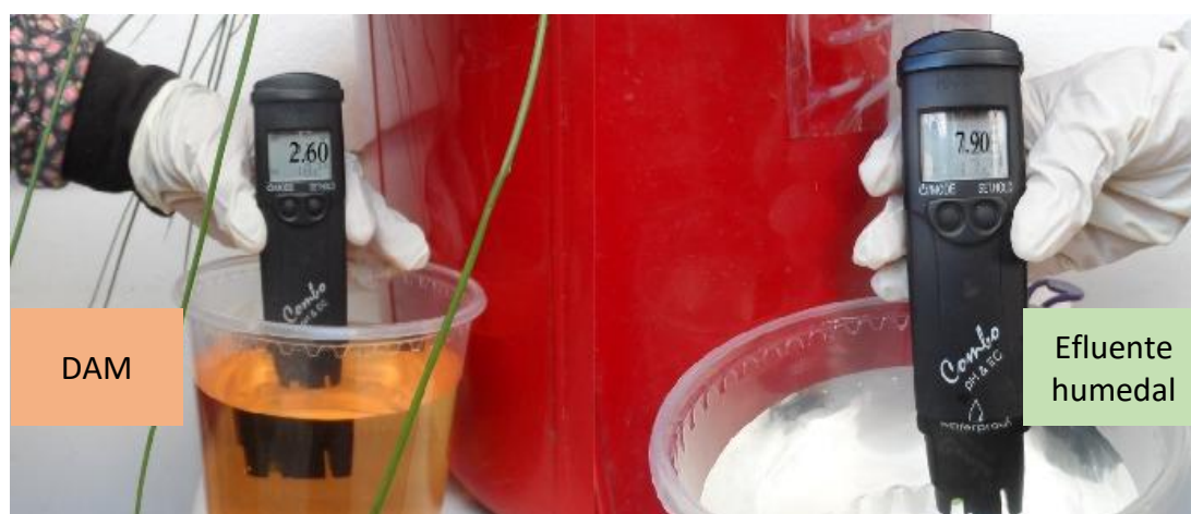
Figura 5. Capacidad biorremediadora del humedal estacionario construido. pH DAM (2,60), pH efluente del sistema (7,90).
