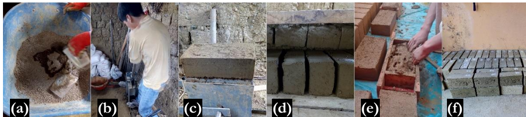
Figura 2. (a) Preparado de la mezcla tierra con cal y/o yeso, (b) compactado del adobe con una máquina casera CINVA – RAM, (c) desmoldaje, (d) zona de secado al aire libre, (e) adobe típico no compactado sin cal o yeso, y (f) almacenaje.
