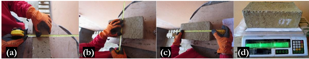
Figura 4. Medición de las (a), (b) y (c) dimensiones y (d) masa de la unidad de adobe.
