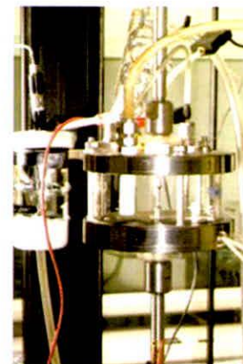
Figura 2. Instalación de las probetas para estudiar el efecto del hidrógeno sobre las propiedades mecánicas del acero AISI 1045.
