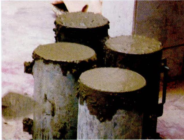
Figura 3. Fabricación de briquetas de concreto
