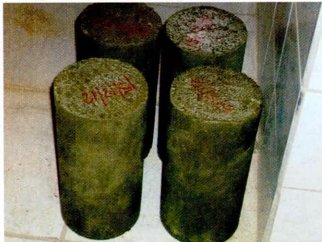
Figura 5. Curado de briquetas de concreto con antisol s.
