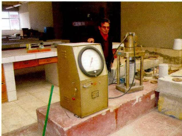
Figura 5. Ensayo de briquetas de concreto en máquina uniaxial. Las resistencias de concretos curados con agua y antisol s, se observa en la tabla 3.
