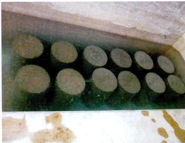
Figura 4. Curado de briquetas de concreto con agua
