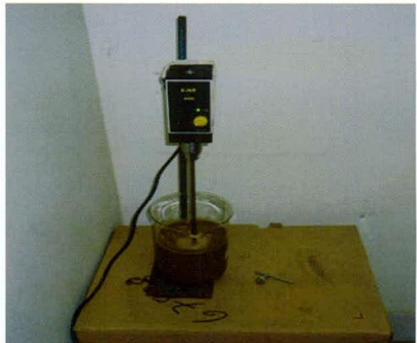
Figura 4. Proceso de Cianuración en el agitador
